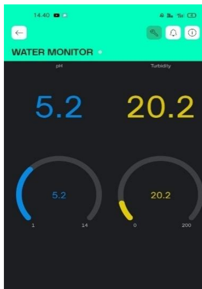
Gambar 5. Tampilan blynk di smart phone pada monitoring kualitas air
